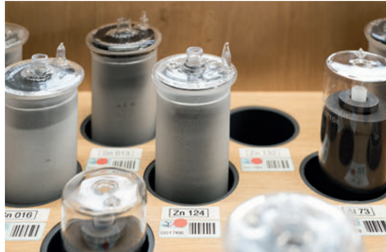
2: Fixpunktzellen bilden mit hochgenauen Normal-Platin-Widerstandsthermometer die ITS-90.
