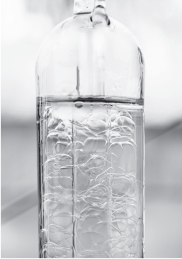
3: Tripelpunktzelle mit Wasser-Eis-Dampf: Sie diente zusammen mit dem absoluten Nullpunkt zur Definition der thermodynamische Temperatur.
