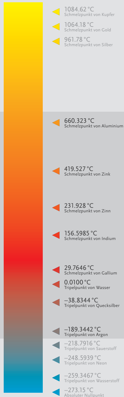
4: Die Temperaturskala ITS-90 wird am METAS mit den hervorgehobenen Fixpunkten von -189 °C bis 660 °C realisiert und ist abgestützt durch die internationalen Messvergleiche EURAMET.T-K9 und EURAMET.T-K3.5.
