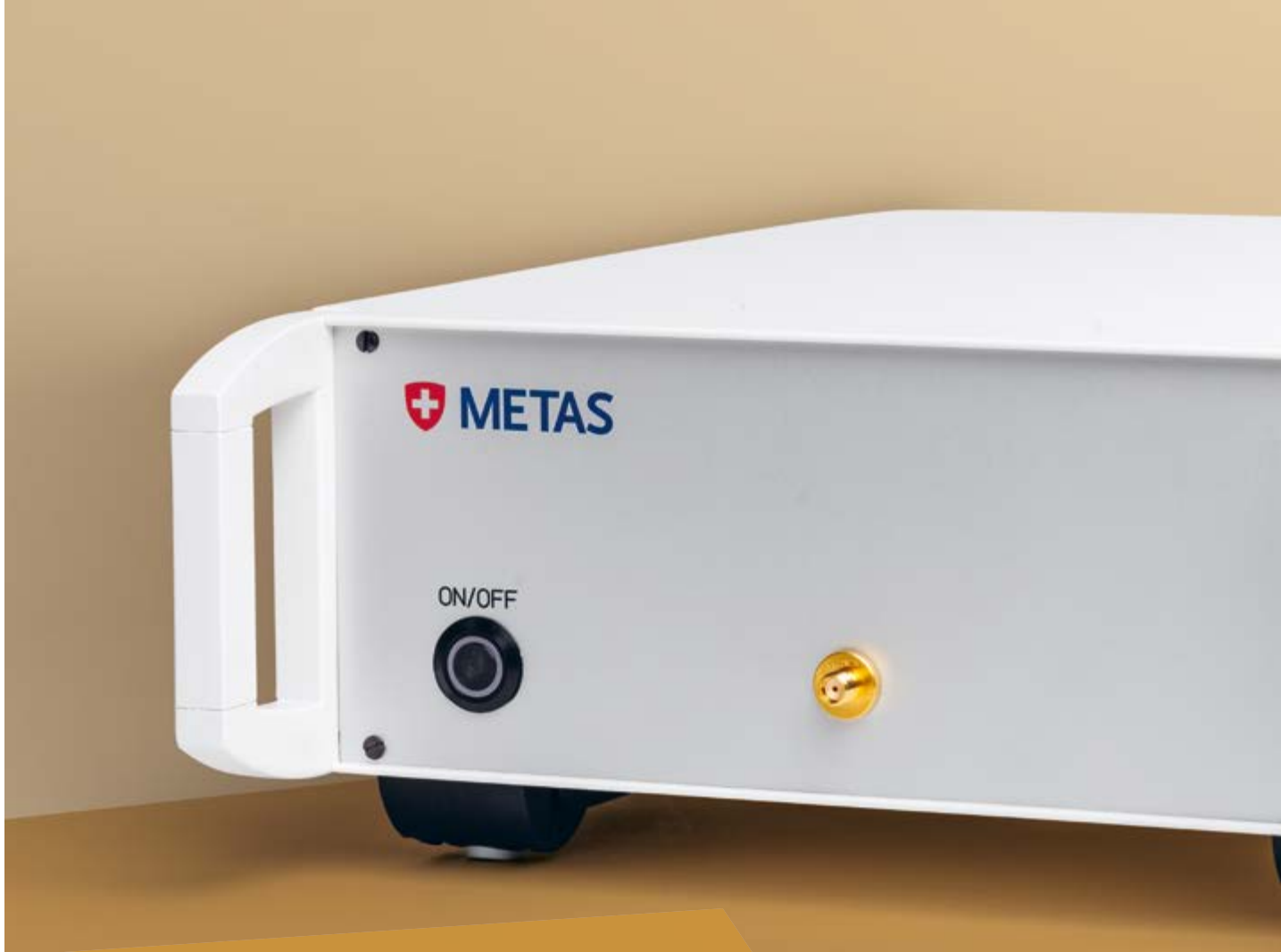
Figure 3: Électronique pour mesures SMM. L'électronique se compose d'une « radio logicielle », d'un « ordinateur à carte unique », d'un générateur de signaux basse fréquence et d'un réseau haute fréquence qui sépare les signaux utiles du SMM des signaux de fond. On raccorde la sonde du microscope à force atomique au connecteur de la face avant à l'aide d'un câble coaxial.
